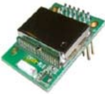
Şekil.6 LM400 Bluetooth modülü
